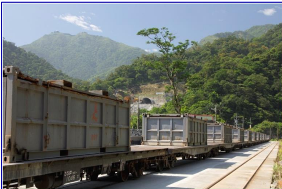
圖 2-7 土方以火車運輸實況照片(蘇花改工程處網站，2014)
