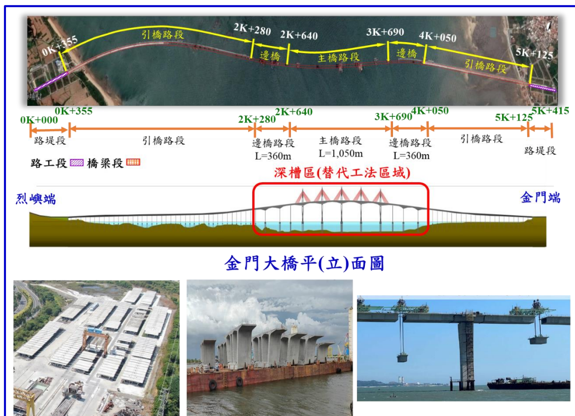
圖 5-8 金門大橋替代工法施作區域示意圖(整理自高速公路局，2021[51])
