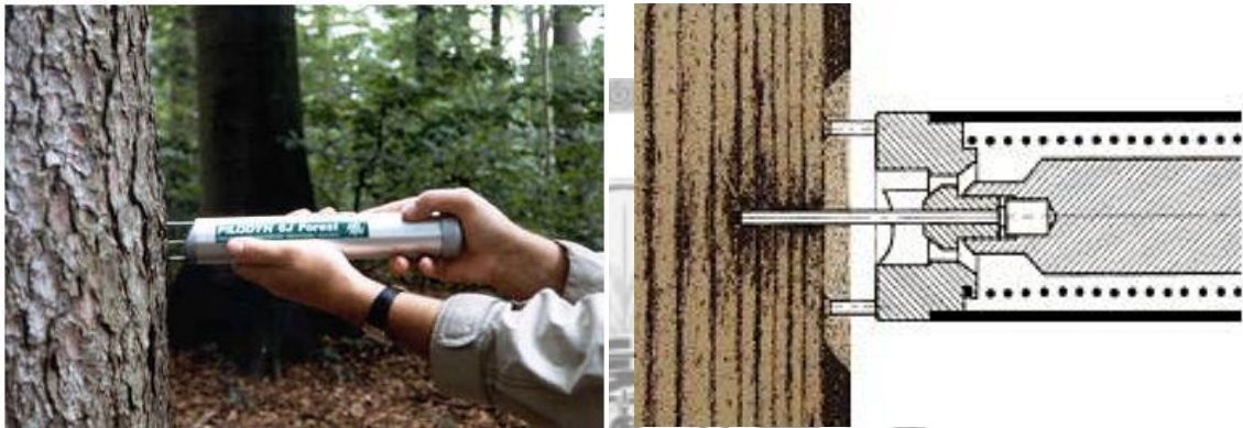
圖 3. 木材腐朽測試器的使用方法及測量狀況示意圖 (PROCEQ SA)
