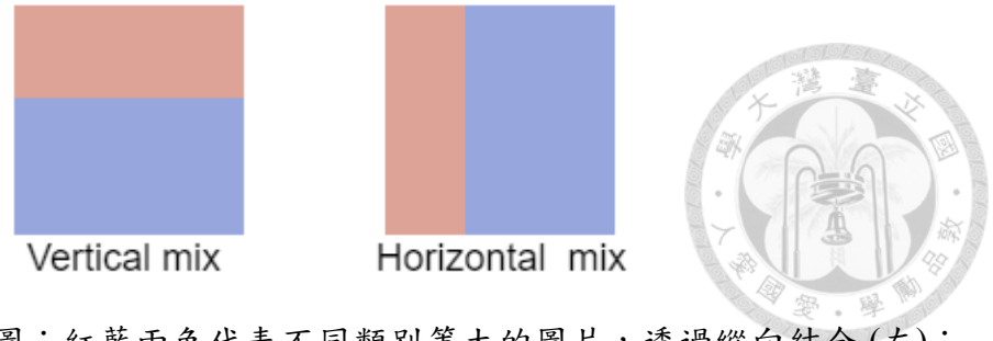
圖 2.6: Mixup 示意圖：紅藍兩色代表不同類別等大的圖片，透過縱向結合 (左)；橫向結合 (右)
