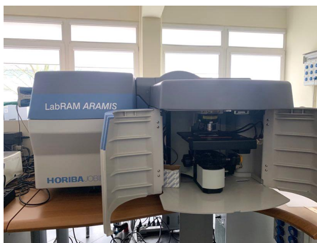
圖 2-12 LabRAM ARAMIS 拉曼光譜儀設備。
