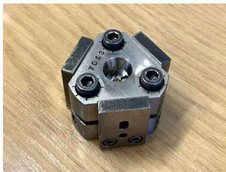
圖 2-18 對螢光粉施加壓力之鑽石鉗。
