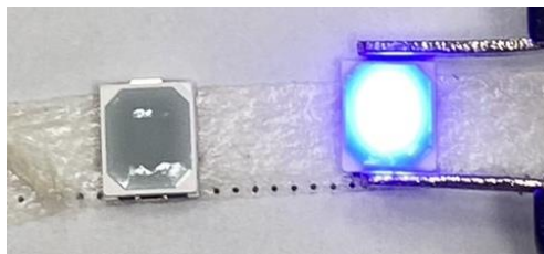
圖 3-63 \text{Mg}_{0.98}\text{Ga}_{1.94}\text{O}_4:0.06\text{Cr}^{3+},0.02\text{Ni}^{2+} 螢光粉之 LED 封裝測試，未通電(左圖)與通電後(右圖)之外觀比較圖(2.8 mm × 3.5 mm 之藍光晶片)。
