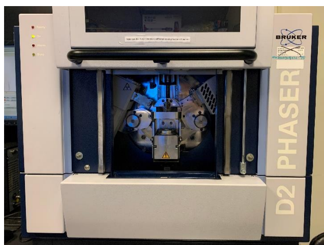
圖 2-4 Bruker D2 粉末 X 光繞射儀。
