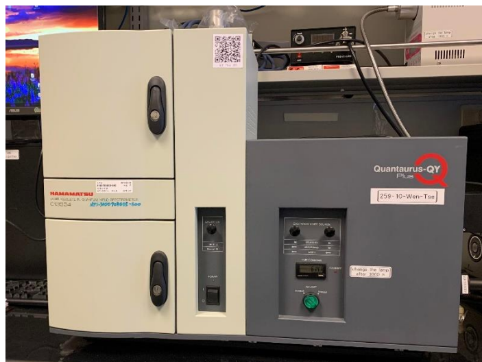
圖 2-16 Hamamatsu 之 Quantaury-QY Plus 量子效率儀。
