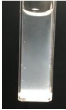
圖 3.4. APC2 在鹼性溶液中的沉澱。 7 天後，因為 APC 奈米粒子的結構崩解，粒子因此聚集並導致沉澱發生。
