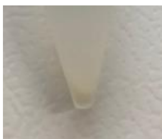
圖 3.2. AP:CS 比例為 1:1.5 時的 APC 沉澱。APC 系統中 CS 的濃度進一步升高至 1.5 mg/mL 可能會導致奈米粒形成大的聚集體，這使得奈米粒大小不穩定且難以測量。
