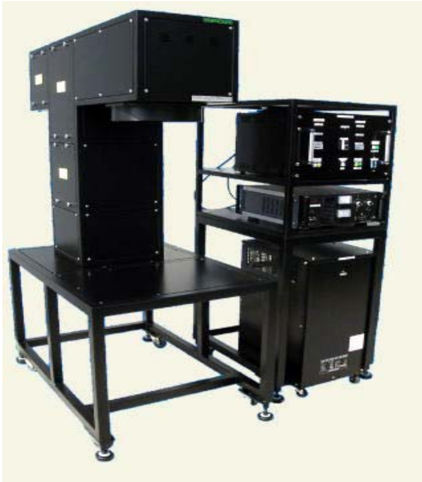
圖 2.4 太陽光源模擬機量測系統。
