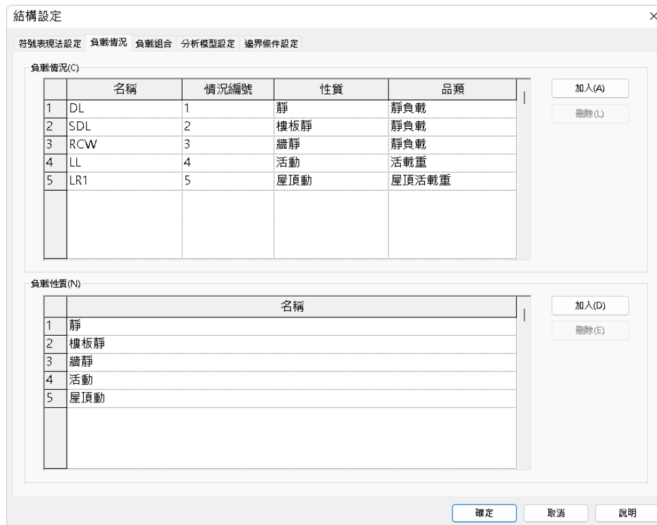
圖 3-25 結構 BIM 模型樣板預設之載重情況
