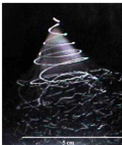
圖 2-3 電紡射流彎曲不穩定之圖像 21
