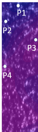
圖 4-99 冷滾 10% \text{Ti}_{50}\text{Ni}_{15}\text{Pd}_{25}\text{Cu}_{10} 箔帶於 4.5% 應變量下之 DIC 即時應變場分析結果
