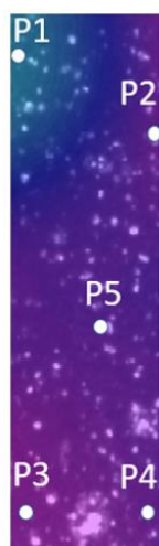
圖 4- 89 \text{Ti}_{50}\text{Ni}_{15}\text{Pd}_{25}\text{Cu}_{10} as-spun 箔帶於 4%應變量下之 DIC 即時應變場分析結果
