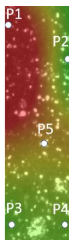
圖 4- 88 \text{Ti}_{50}\text{Ni}_{15}\text{Pd}_{25}\text{Cu}_{10} as-spun 箔帶於 4%應變量下之 DIC 應變場分析結果
