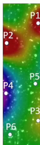
圖 4- 18 \text{Ti}_{48.9}\text{Ni}_{49.1}\text{Fe}_2 500°C時效 24 小時之箔帶於 0.95%應變量下之 DIC 應變場分析結果
