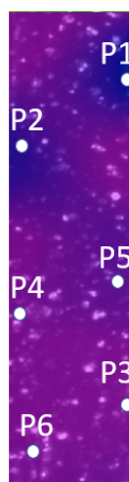
圖 4- 19 \text{Ti}_{48.9}\text{Ni}_{49.1}\text{Fe}_2 500°C時效 24 小時之箔帶於 0.95%應變量下之 DIC 即時應變場分析結果
