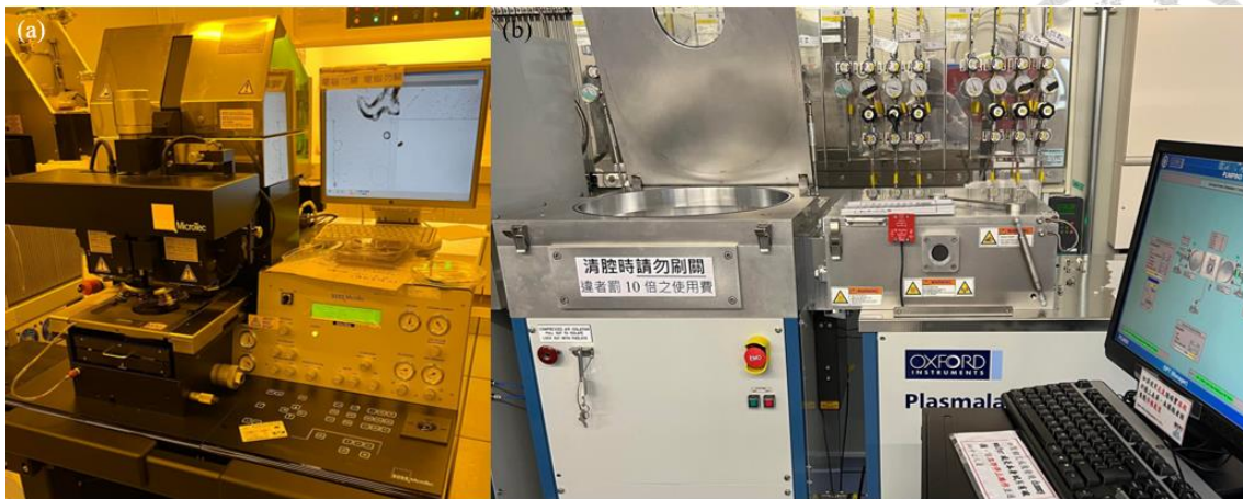
圖 3-7 (a)曝光機(Karl Suss Aligner, MA6)。(b)活性離子乾蝕刻機 Oxford RIE
