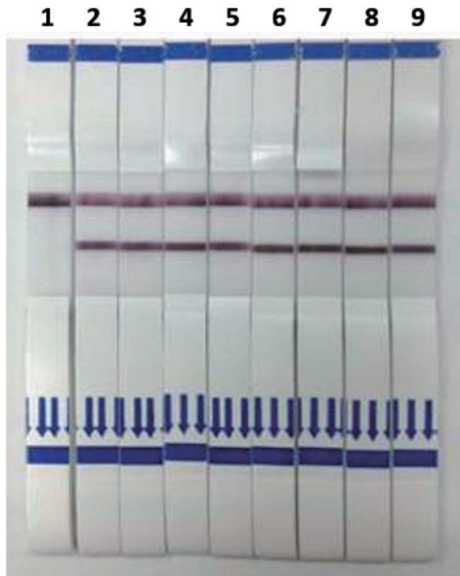
圖二、核酸檢驗試劑測試結果。試劑1為負對照組，試劑2至9為分別在不同PCR黏合溫度下 (53.6°C、54.2°C、55.4°C、56.8°C、58.2°C、59.7°C、61.6°C、62.6°C)產生之產物反應結果。
