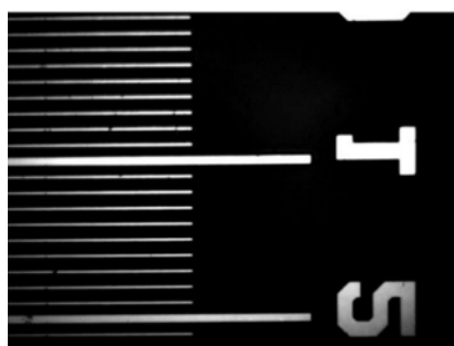
圖 2.14 左圖為解析度測試片，右圖為數字 1 刻紋亮暗邊界之歸一化訊號強度。
