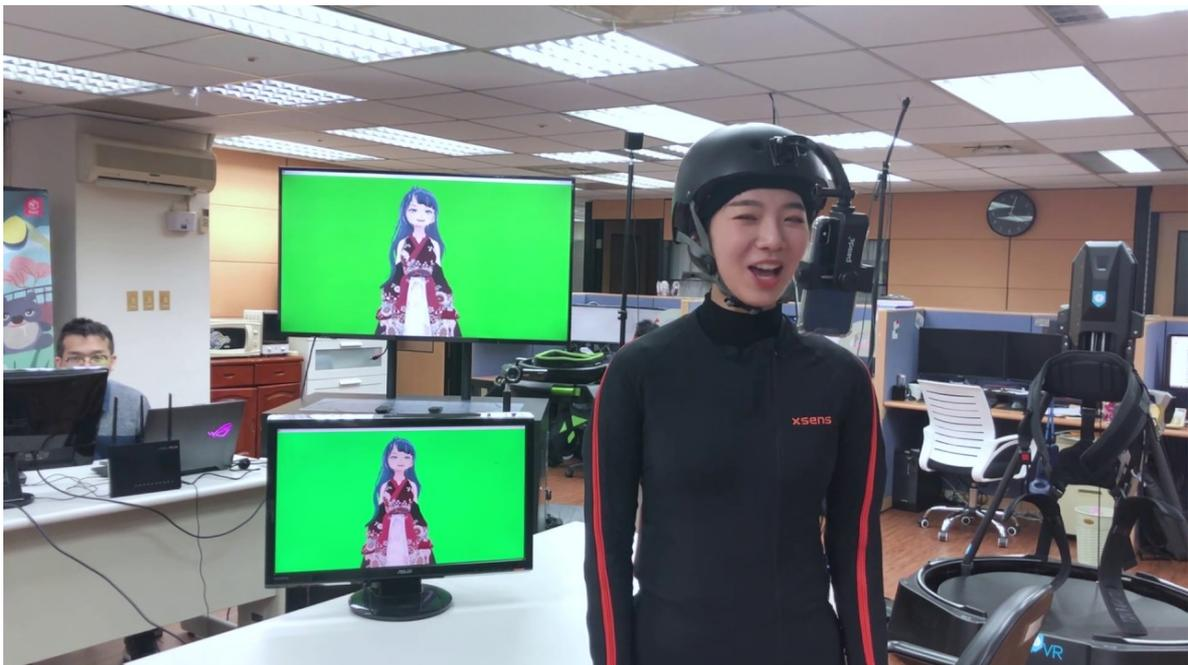
圖 18 簡易動作捕捉設備 Xsens 穿戴，靠身體動量偵測捕捉角色動作。
