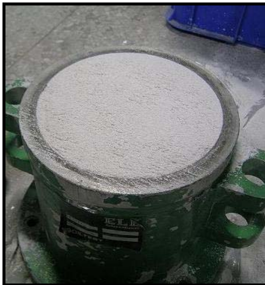
圖 3.11 最小乾土單位重試驗
