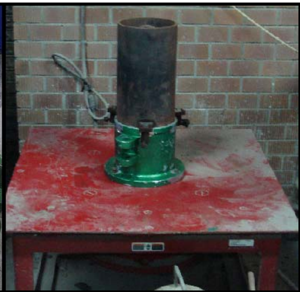
圖 3.12 最大乾土單位重試驗
