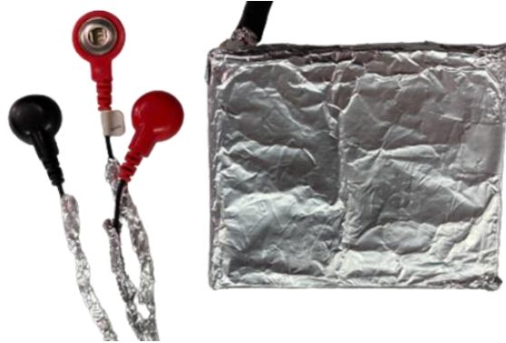
圖 25. 導線及電路外殼皆以鋁箔紙包裹接地
