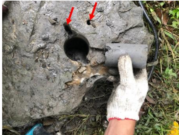
圖 2-2-4、從鑽孔中取出岩心。於岩心鑽孔旁鑽斜向孔(箭頭)至岩心，再使用一字起子敲擊岩心，岩使心斷裂，之後用鐵絲套環將岩心取出。
