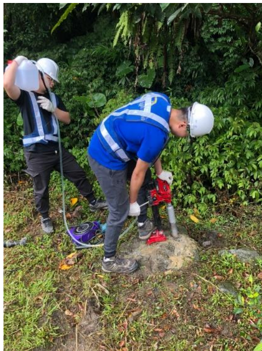
圖 2-2-3、使用岩心鑽機鑽取岩心。於高處架設水桶(必要時由另一人扛著，鑽進期間需不停供水)，打開水匣，啟動鑽機，轉動把手下壓鑽管，使鑽管向下前進。
