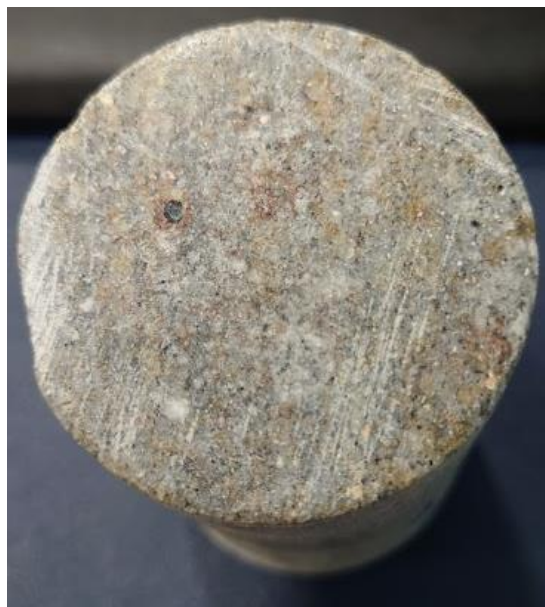
圖 4-2-1、四稜砂岩變質砂岩。照片為四稜砂岩岩心橫剖面，其中可見白色顆粒為石英，觀測所佔礦物比例很高。
