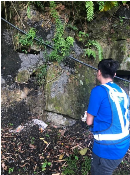
圖 2-2-5、使用地質槌敲擊風化露頭，取內部較為新鮮的岩石樣本。
