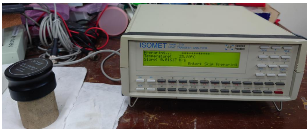
圖 2-5-1、熱導係數儀實際測量樣本的照片。
