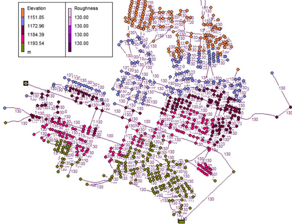
圖 2-18 自來水管網 EPANET 模型節點高程與管線粗糙度設定
