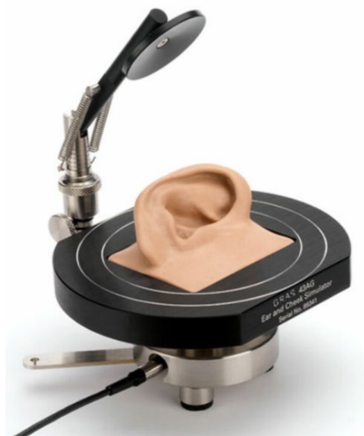
圖 5-13 人工耳(GRAS 43AG-9 Hi-Res Ear Simulator)
