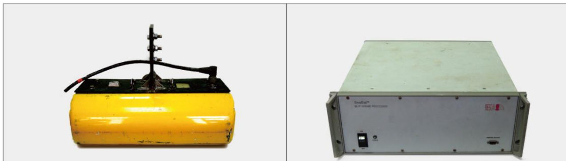
圖 1-5：多音束測深系統。 左為 Reson Seabat 8125 音鼓，右為同型號主機。
