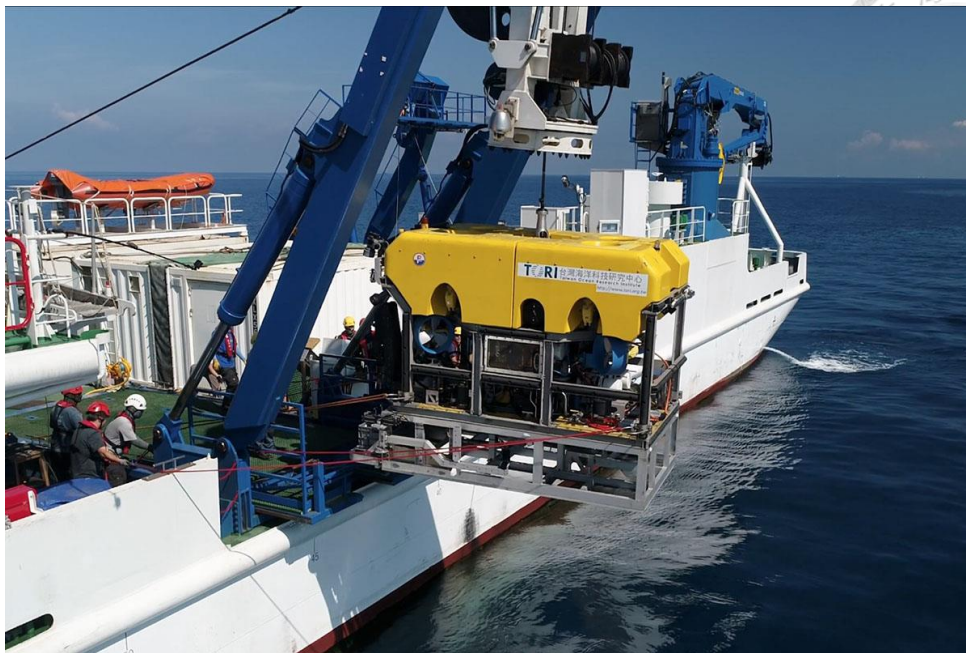
圖 1-11：TORI 的深海工作型 ROV。(台灣海洋科技研究中心) 後方甲板上的兩個白色貨櫃為 ROV 控制室。
