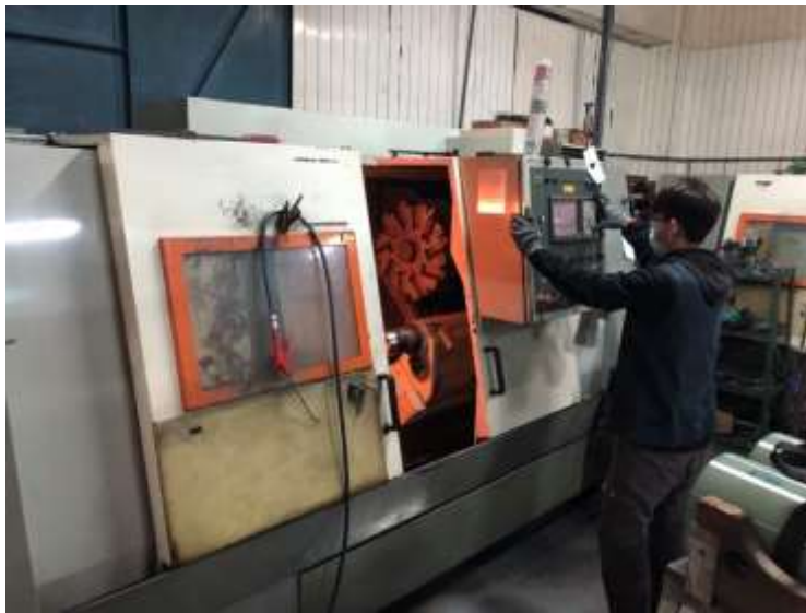
圖 4 忠興工業的作業員操作 CNC 電腦車床
