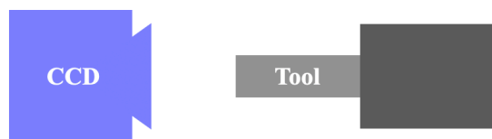
圖 20 刀具磨耗之拍攝方式示意圖
