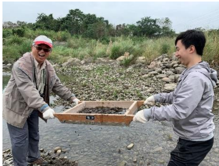
圖 3.1 砂箱礫石之採集過程（現地篩分析）
