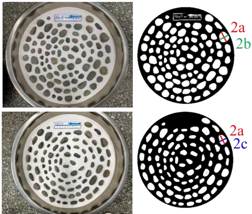
圖 3.2 利用影像自動辨識軟體測定礫石之基本材料性質
