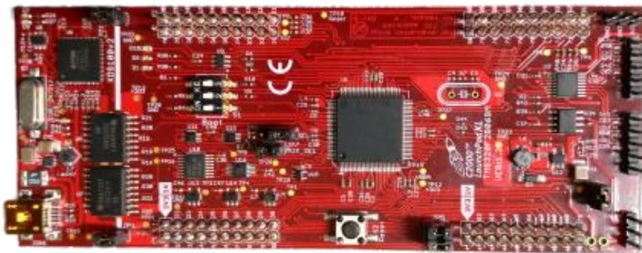
圖 6.12 LAUNCHXL-F28069M 數位訊號處理器實體圖
