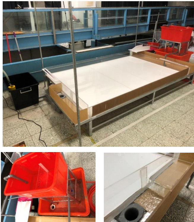
圖 3.2-1 水槽照片、頭水箱照片與尾水堰板照片
