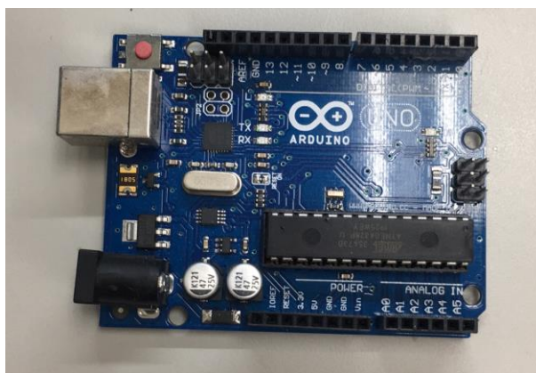
圖 3.40 Arduino Uno 板的實體
