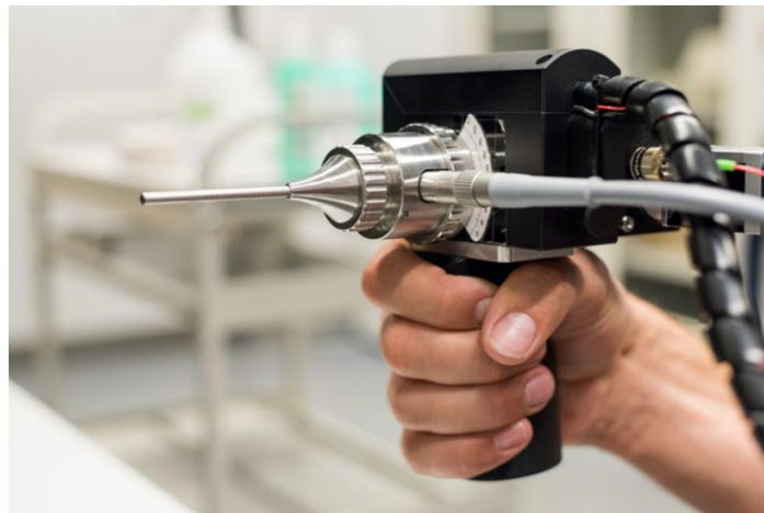
圖 1.7 用於插入耳道的內視鏡式 OCT 系統[7]
