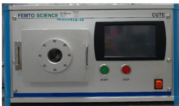
圖 3-18 氧電漿機 Model CUTE-MPR
