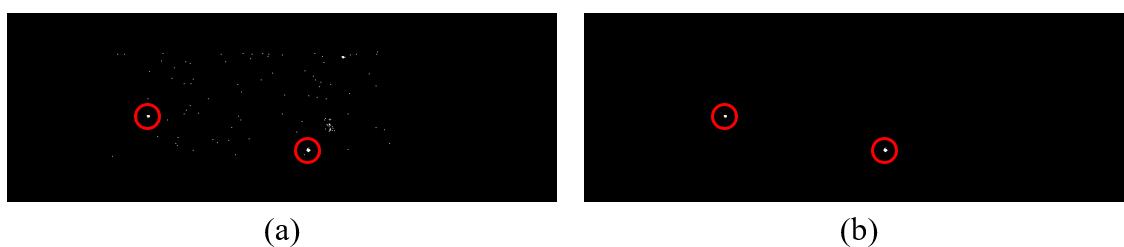
圖 4-40 Threshold = 15 二值化影像 (a). 未使用 Remove Particle.vi (b). 使用 Remove Particle.vi
