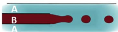
圖 2-22 共伴流液珠生成流道(Alkayyali et al. , 2019)
