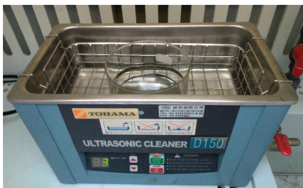
圖 3-10 矽晶圓於超音波振洗槽內清洗
