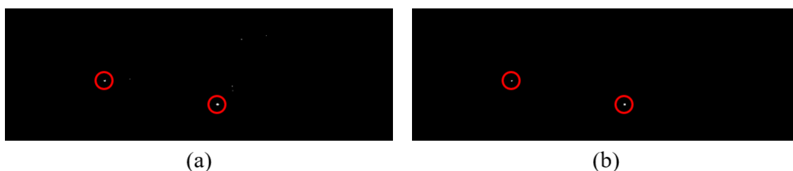
圖 4-39 Threshold = 20 二值化影像 (a). 未使用中值濾波 (b). 使用中值濾波
