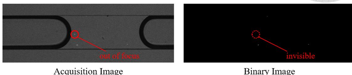
圖 4-35 失焦造成影像中螢光訊號模糊
