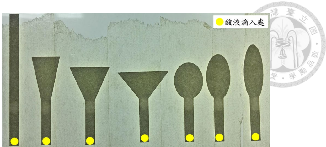
圖 3-5 各式紙基底實際使用圖(紙片上較淺色處為酸液位置)
