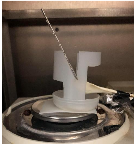
Fig. 3.3-1 瀝乾法之實驗裝置圖
