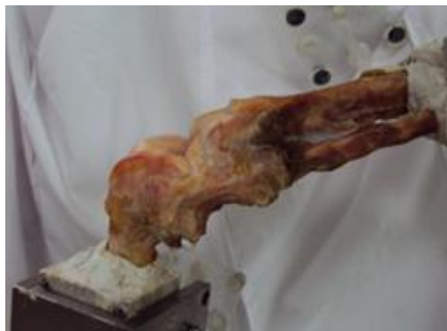
圖 2-3、以塑鋼土將試體固定於夾具，股骨夾具鎖於測試臺
