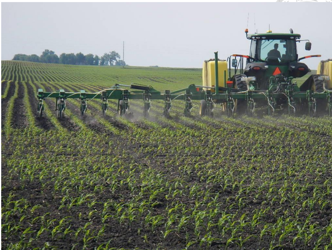
圖 3-3-4 美國養豬農民以大型農機注灌豬糞尿於玉米田
