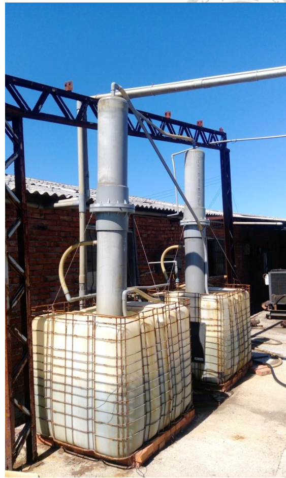
圖 3-2-17 日製淘汰柴油卡車引擎改裝發電機及自製水脫硫塔
