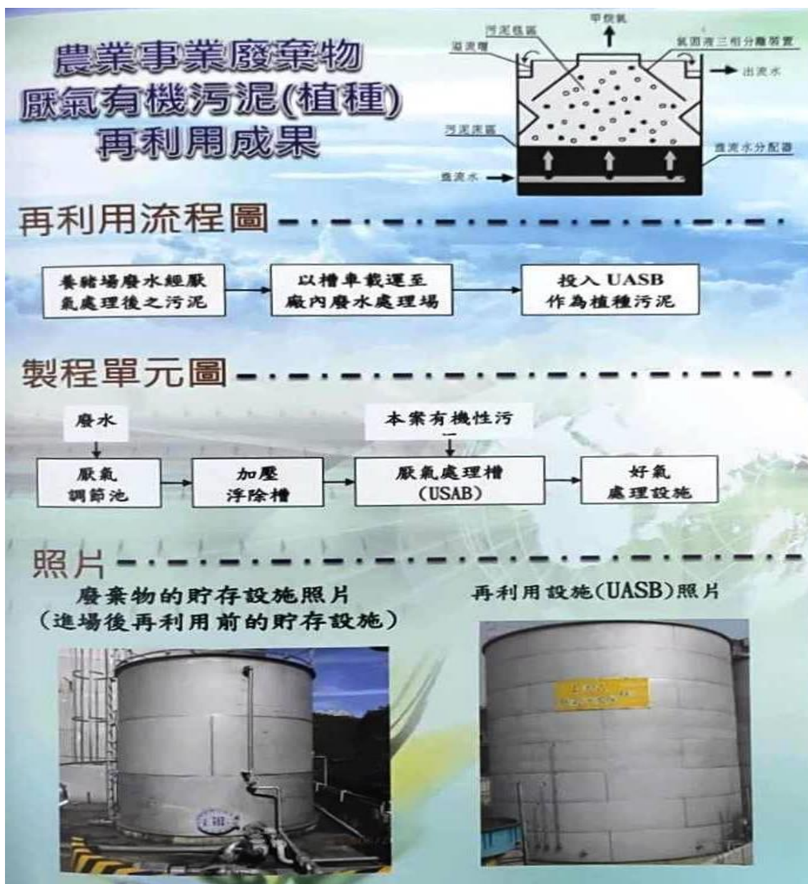
圖 3-3-6 植種污泥與 UASB 流程
