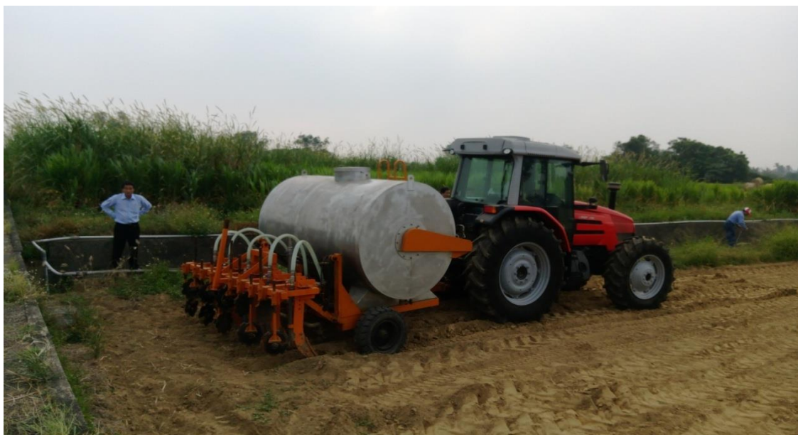
圖 3-2-6 沼液沼渣施灌示範，曳引車牽引液肥車直接注入農地
