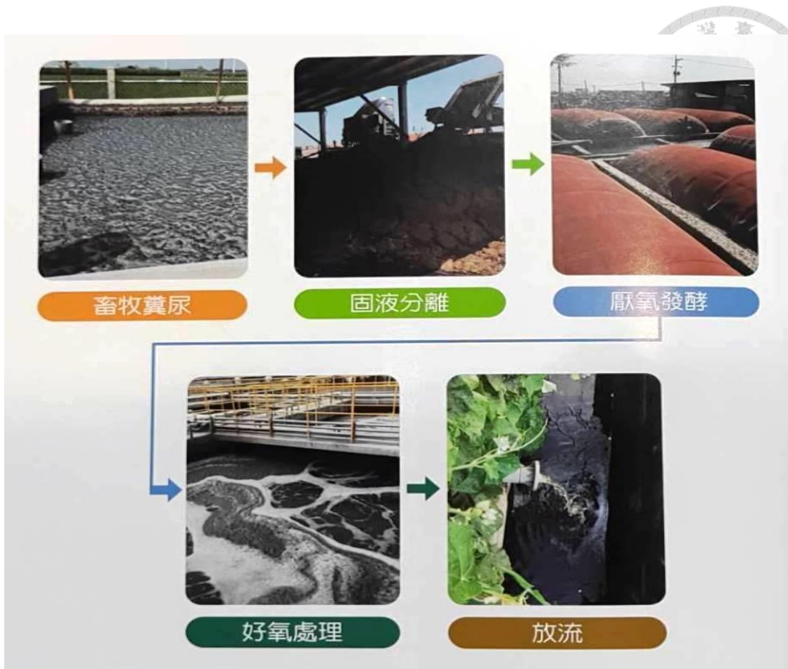
圖 3-2-5 三段式廢水處理流程
