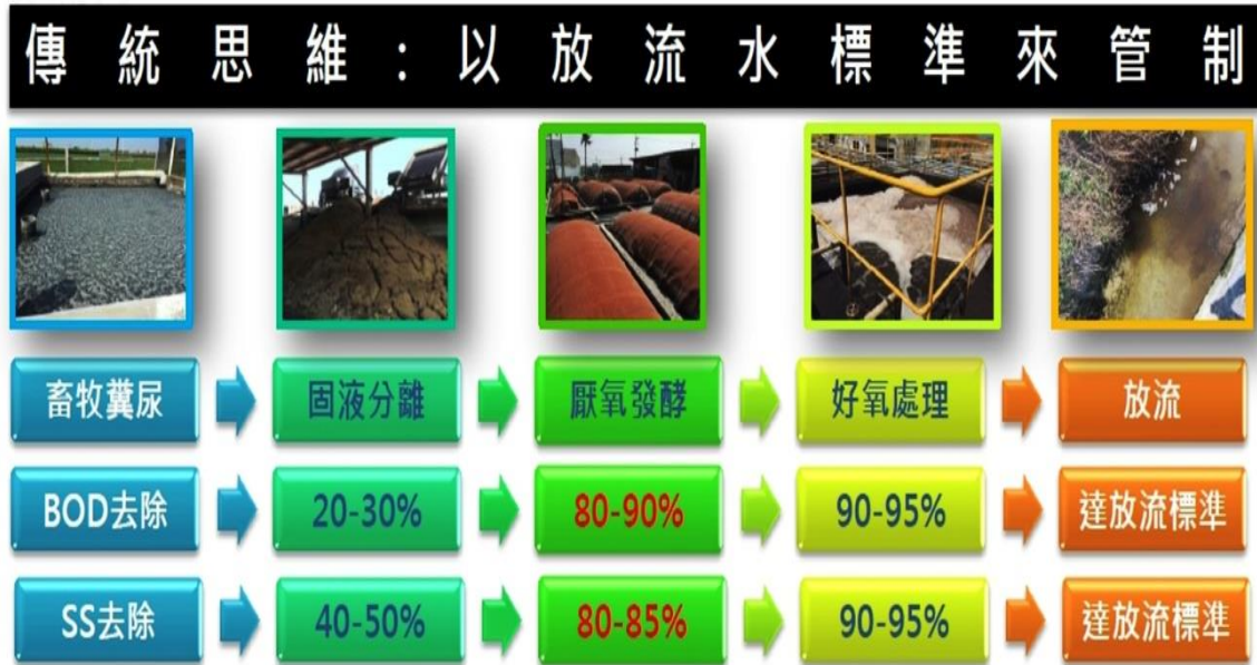
圖 3-2-2 養豬場三段式廢水處理的目標朝放流水標準之程序
