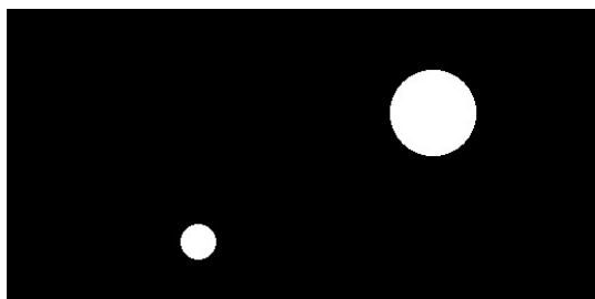
圖 3.2.1 不同粒徑之人造二值化影像 I(x, y, t_3) 與互相關 C_y(x, t_3) ; (1)、(2)、(3) 依序為顆粒二 P_2 直徑為 11、30 與 75 個像素的第三幀人造二值化影像 I(x, y, t_3) ; (4)、(5)、(6) 依序為顆粒二 P_2 直徑為 11、30 與 75 個像素時 \hat{D}_y(x, t_3) 與 \hat{D}_y(x, t_2) 的互相關 C_y(x, t_3) 在區間 [-30, 50] 的放大圖。
