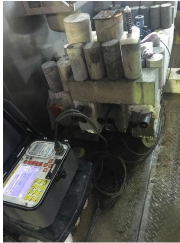
照片 4-27 鋼筋腐蝕電流量測儀器設置
