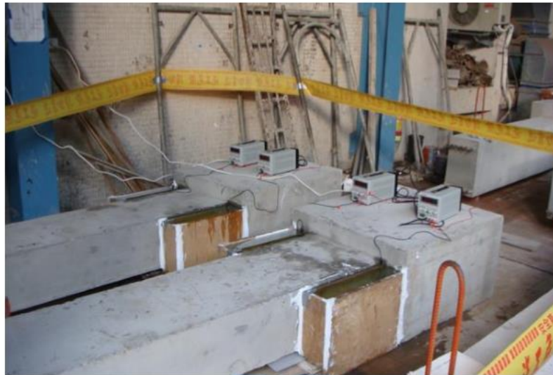
照片 3-5 主筋通电腐蝕方式[142]
