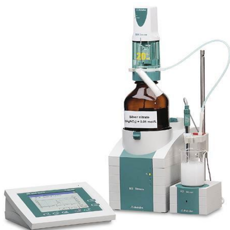
照片 4-19 Metrohm 809 電位滴定儀
