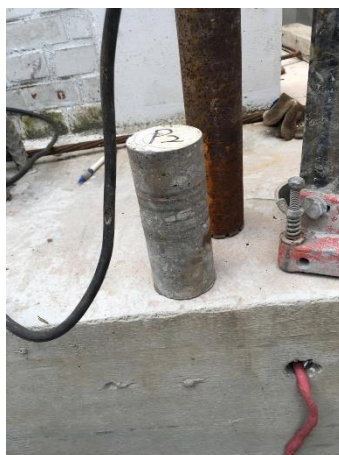
照片 4-29 鑽心取樣試體
