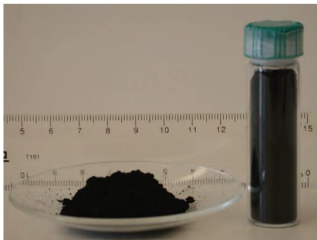
圖 2.2-8 溶熱合成法製作之石墨烯[69]
