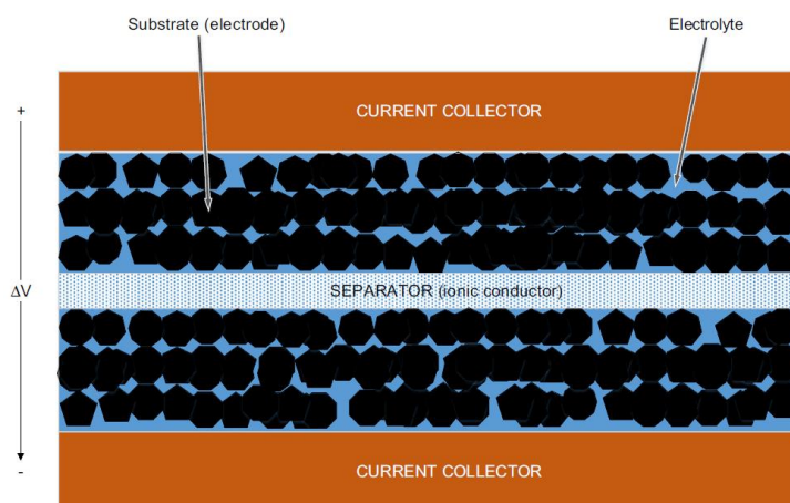
圖 2.4-2 典型超級電容之構造[119]
