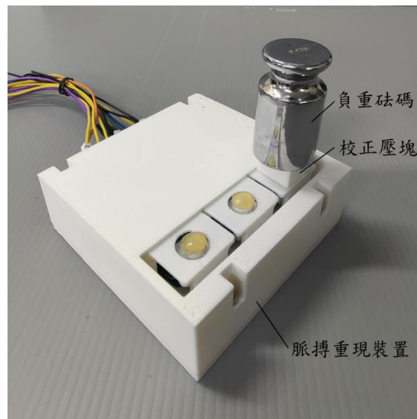
圖 5-12 脈搏量測裝置壓力校正示意圖
