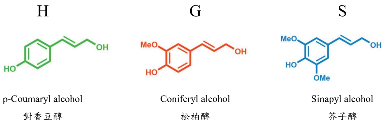
圖 2. 木質素單體結構 (Kärkäs et al., 2016)
