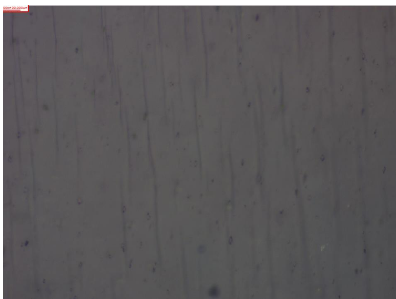
圖 4.8 軟性基板上 ITO 裂痕之光學顯微鏡圖
