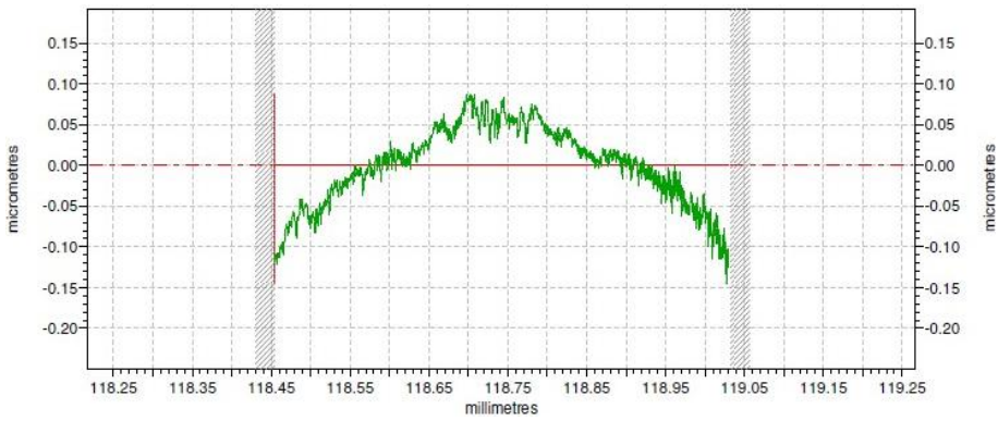
圖 5.6 Surface 3 - FOV 60° 形狀精度示意圖
