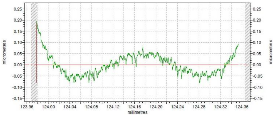
圖 5.7 Surface 4 - FOV 30° 形狀精度示意圖
