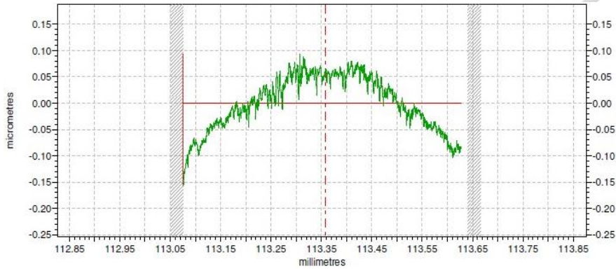
圖 5.5 Surface 3 - FOV 30° 形狀精度示意圖
