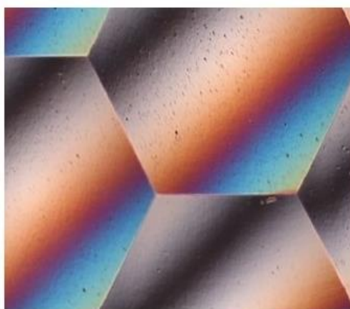
圖 1.6 蜂巢式非球面陣列透鏡之加工成品[6]
