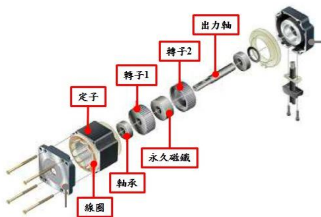
圖 4-17 步進電機內部結構示意圖
