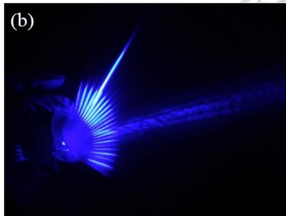
圖 4-15 改進後之 PDMS 光柵鍍膜後彎曲之實照與其在彎曲下之繞射行為
