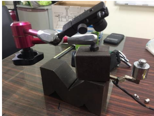
圖 21 標準砝碼放置於懸臂式力量感測器校正
