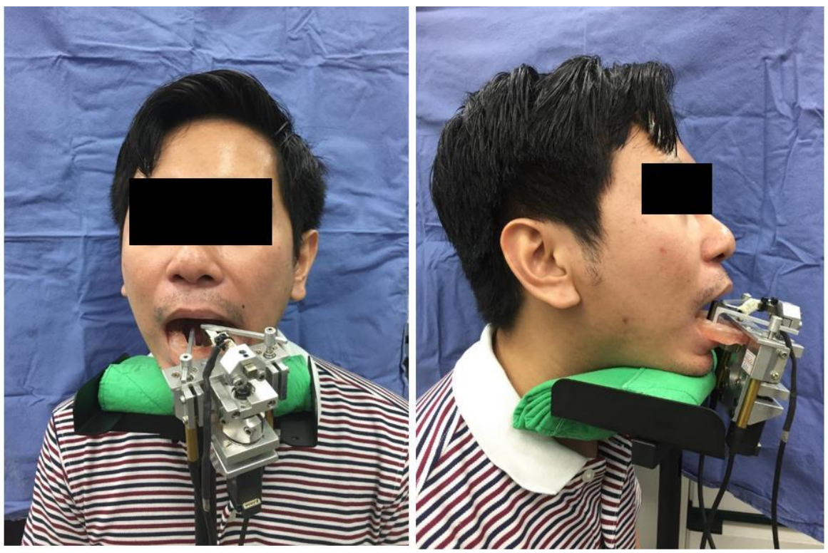
圖 20 口內量測儀器及個人牙托總成裝置於口內狀況
