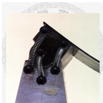
圖 4-14 支撐塊轉軸固定方式
