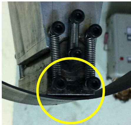
圖 4-6 施力塊與積層板僅兩端線接觸
