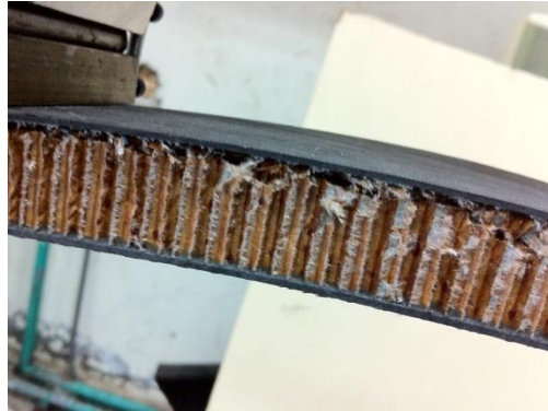
圖 5-18 表材與芯材間發生脫膠破壞
