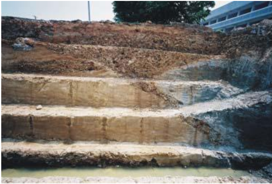
圖 1-22、開挖通過新城斷層之槽溝。槽溝顯示卓蘭層逆衝到晚更新世的砂礫層之上，斷層傾角向東南方(陳文山等，2003)。
