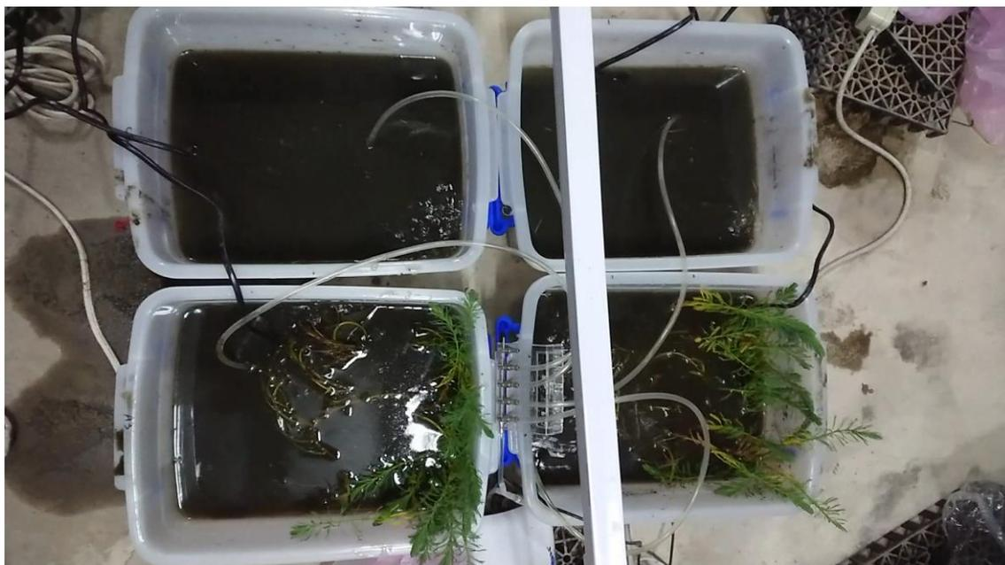
圖 3.2.6.1 利用打氣馬達保持實驗水體流動並增加水中溶氧
