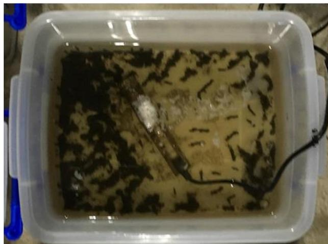
圖 3.2.5.1 石英加熱棒放入塑膠整理箱中加熱水體、保持水溫
