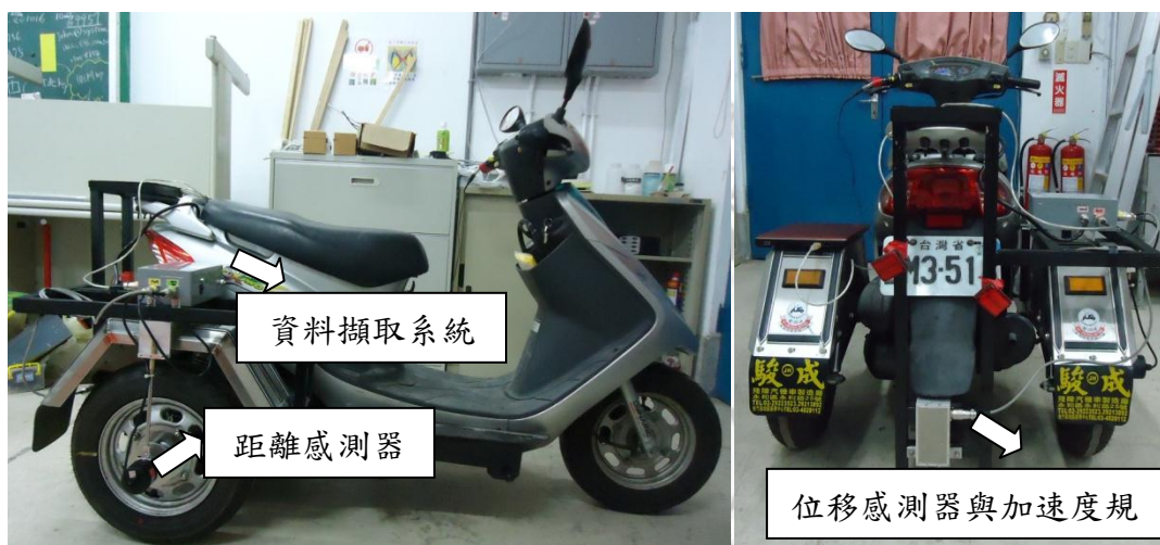
圖 3.7 輕量型慣性式平坦儀儀器裝設圖
