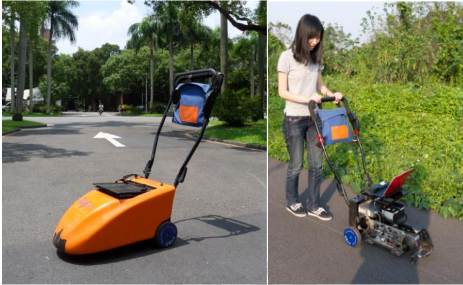
圖 2.8 步進式平坦儀及其實際檢測情況
