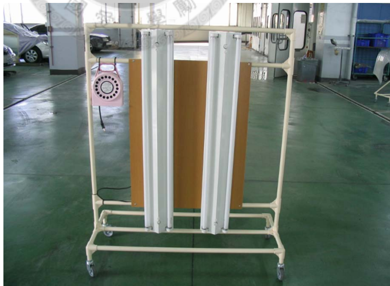
完工檢查照明燈架
