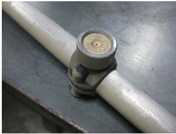
圖 4-6 廖 (2001) 實驗使用的螺旋水流型噴嘴
