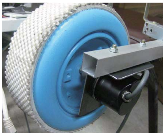
圖 3-17 旋轉編碼器與模型車輪之連接
