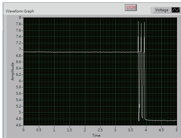
圖 4-42 間隔時間 0.05 秒，馬達電壓由 5.0 V 下降至 4.0 V
