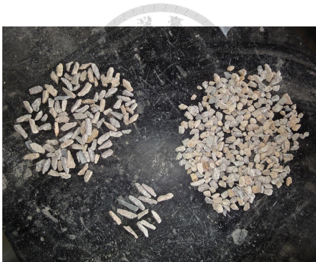
圖 4.3 粗粒料 A(#4 級配)顯著存在之細長石
