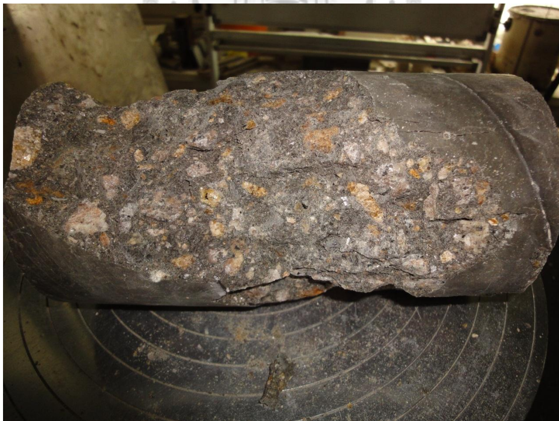
圖 4.24 AS0 九十天齡期抗壓試體破壞面
