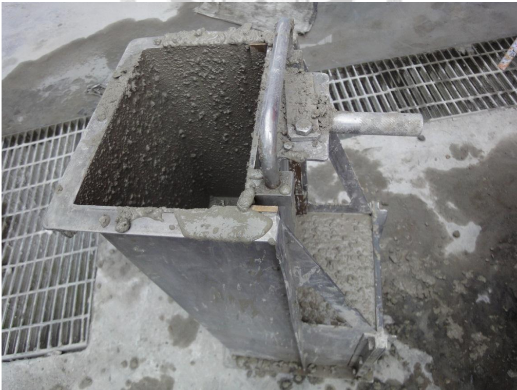
圖 4.16 BP 配比箱型試驗情況
