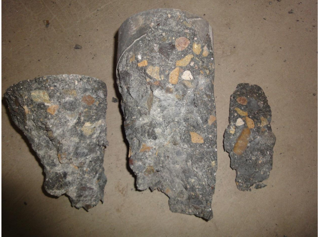
圖 4.27 BP 九十天齡期抗壓試體破壞面
