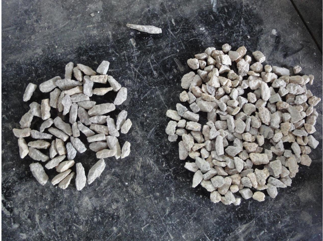
圖 4.4 粗粒料 A(3/8 級配)顯著存在之細長石
