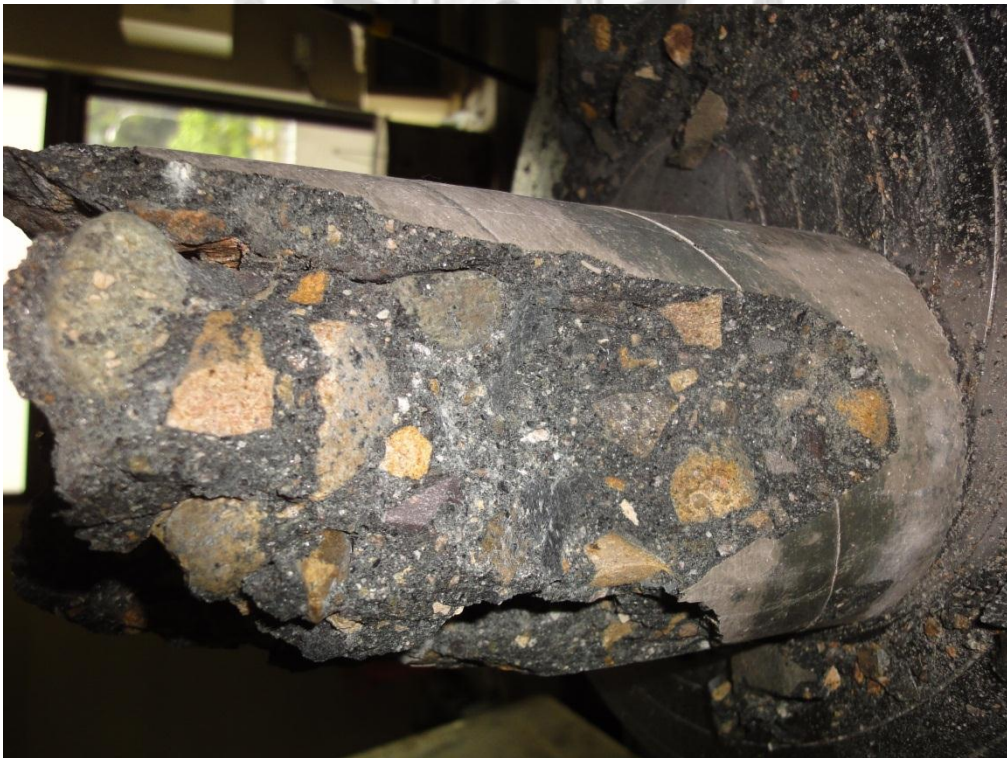
圖 4.26 BS45 九十天齡期抗壓試體破壞面
