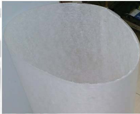
聚丙烯不織布貼上聚丙烯薄板後，將薄板捲成圓筒狀並固定。
