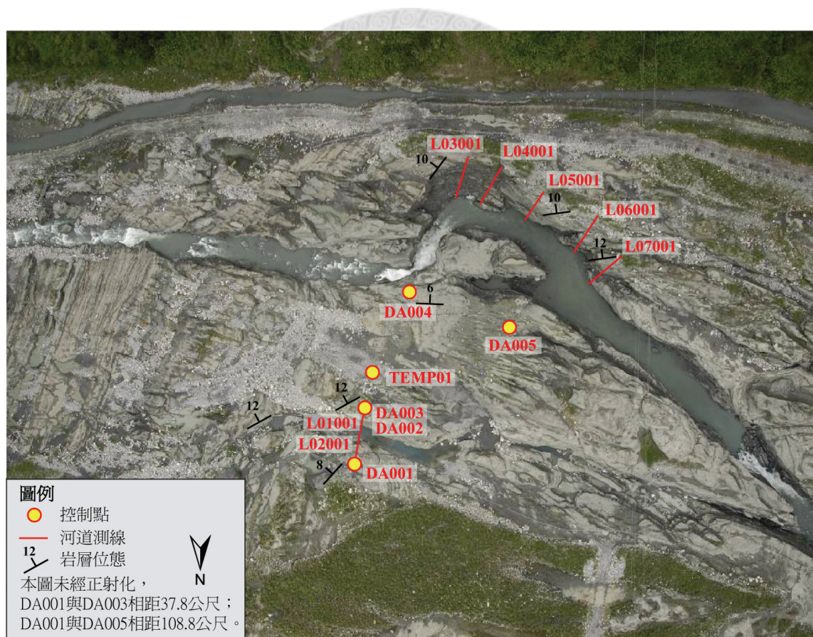
圖 4-4 控制點與河道測線分布圖 (本圖北方朝下)
