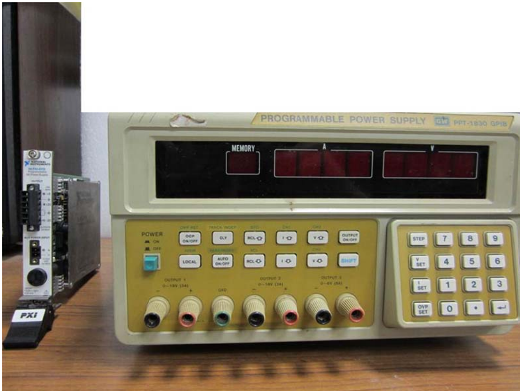
圖 3.1 傳統(右)與 PXI(左)可程式化電源供應器
